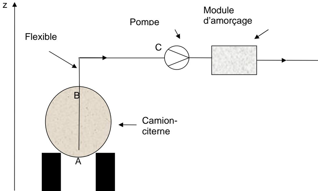
On souhaite vérifier qu'il n'y a pas de risque de formation de vapeurs (cavitation) à l'entrée de la pompe.
