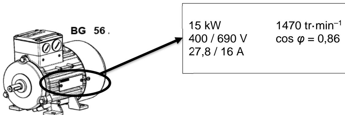
**Q18-** Déterminer, en justifiant la réponse, le couplage du moteur.
