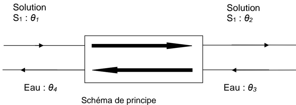
On notera  $\Phi$  le flux de thermique échangé par le fluide chaud et le fluide froid.
